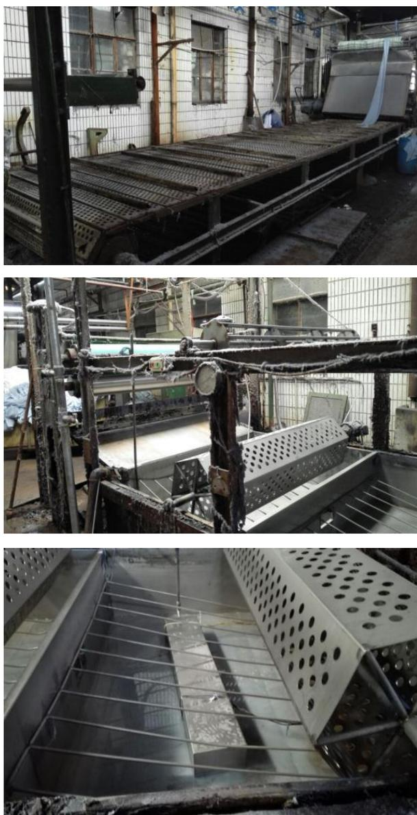
图 4-1 超声波辅助退浆装置在企业的中试装置图
